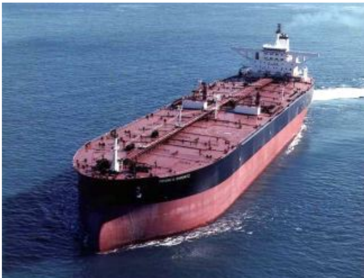
Antares Voyager, una VLCC a doppio scafo, di cui Veronelli è stato alla Direzione Macchine. Capace di 308.000 di greggio. Potenza apparato motore kV 24850 e velocità di 15,3 nodi a pieno carico.
